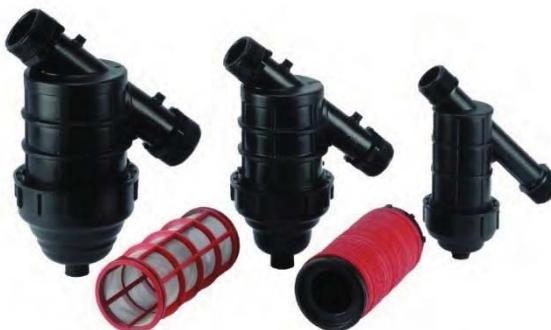
**Технические характеристики:** Материал корпуса: технический пластик. Материал фильтрующих дисков: усиленный полипропилен. Максимальная рабочая температура: 60°C. Максимальное рабочее давление: до 8 атм. Тонкость очистки: 130 мкм.
