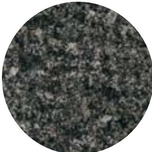
**Ecotar-A** для очистки воды от растворенного железа, комплексных железоорганических соединений, марганца, солей жесткости. Рекомендуется для очистки воды из колодцев и неглубоких скважин. Визуальная оценка исходной воды: вода имеет желто-бурую окраску, при отстаивании образуется осадок.
